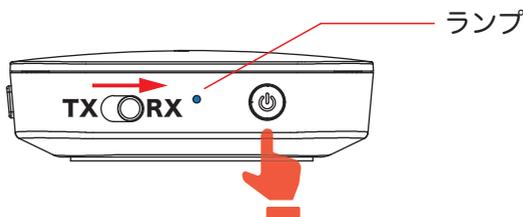
**2** 電源ボタンを長押し（約 3 秒間）するとランプが 2 度点滅して電源オンの状態になります。
